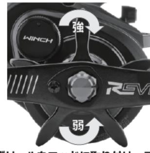
ドラグとは、魚が強く引いたときにラインを切られないように魚の引く力に合わせてラインをスムーズに送り出すシステムです。正確にドラグを調整するには「バネばかり」を使用すると良いでしょう。スタートドラグを回転させてドラグ力を調整を行います。
