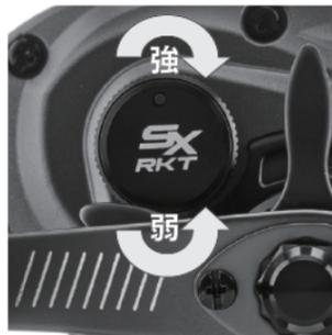
ノブを強く締めるとスピールの左右のガタが無くなりスピールにブレーキ力が発生します。ノブを弱く緩めるとスピールフリーが向上します。通常はスピールの左右のガタが無くなる程度に調整します。風が強く、キャスト時に糸が浮く時に締めこみ調整します。
