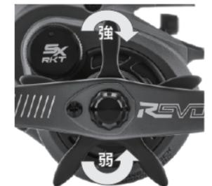
ドラッグとは、魚が強く引いたときにラインを切られないように魚の引く力に合わせてラインをスムーズに送り出すシステムです。正確にドラッグを調整するには「バナばかり」を使用すると良いでしょう。スタードラッグを回転させてドラッグ力の調整を行います。
