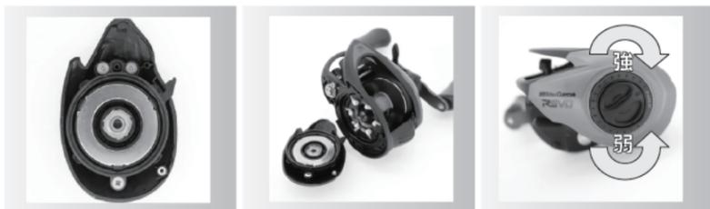
本機種のブレーキは遠心ブレーキを採用しております。ブレーキ力の調整は外部ダイヤルにて調整可能です。(スプール側の白いブレーキユニットは取り外し出来ません。)キャスティング時にバックラッシュ防止のため、スプールにブレーキ力が必要な場合は、本ブレーキのダイヤルを強側(MAX側)に調整して下さい。ルアーのウエイトや、風の状況により強弱を調整して下さい。ピッチングするときはブレーキを弱く設定して下さい。写真は右ハンドル仕様です。
