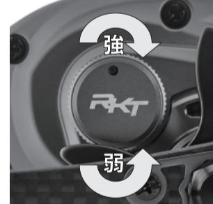
ノブを強く締めるとスプールの左右のガタが無くなりスプールにブレーキ力が発生します。ノブを弱く緩めるとスプールフリーが向上します。通常はスプールの左右のガタが無くなる程度に調整します。風が強く、キャスト時に糸が浮く時に締めこみ調整します。
