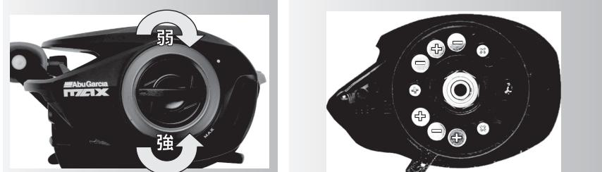
本機種のブレーキプレートはマグネットが6箇所装着されています。ブレーキが強い場合はお好みでマグネットの個数を調整することにより微調整が可能です。取り除く場合はドライバーの先などにマグネットをくっつけて外してください。マグネットは+/-が図のように交互に配列するようにセットしてください。装着する際は隣の磁石と向きが同じようにならないよう注意してください。
