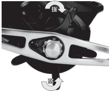
ドラグとは、魚が強く引いたときにラインを切られないように魚の引く力に合せてラインをスムーズに送り出すシステムです。正確にドラグを調整するには「バネばかり」を使用すると良いでしょう。スタードラグを回転させてドラグ力の調整を行います。
