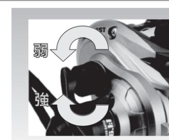
ノブを強く締めるとスピールの左右のガタが無くなりスプールにブレーキ力が発生します。ノブを弱く緩めるとスプールフリーが向上します。通常はスピールの左右のガタが無くなる程度に調整します。風が強く、キャスト時に糸が浮く時に締めこみ調整します。
