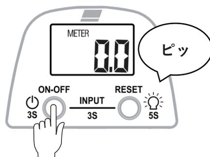
仕掛けの準備ができたなら**ON-OFFボタン**を3秒押ししてカウンターを表示させてください。
