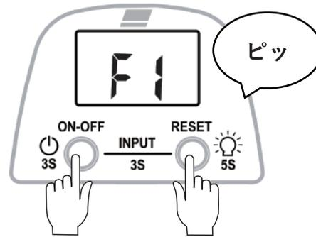
② ON-OFFボタンとRESETボタンを同時に3秒押してください。下図の手順でF1を選択してください。
