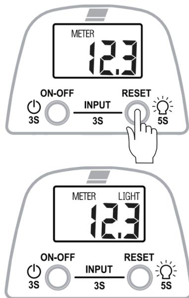
電源ONの状態では**RESET**ボタンを5秒押し続け、LEDライトが点灯したら、すぐに指を離してください。
