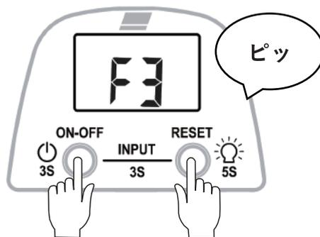
② **ON-OFFボタンとRESETボタンを同時に3秒押し**てください。下図の手順でF3を選択してください。
