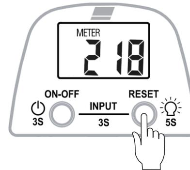
⑧ 20mの糸の引き出しを終えると、カウンターに、スプール回転数が表示されます。**RESETボタンを1回押し**てください。
