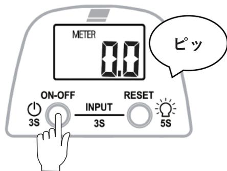
① スプールの下巻き糸と上巻糸を結んだ状態から **ON-OFFボタンを3秒押し**てカウンターの表示をONにしてください。
