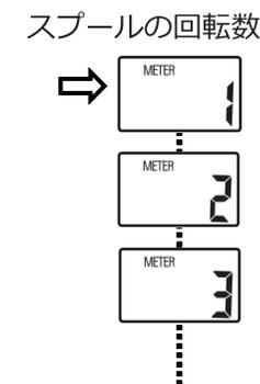
④ **ハンドルで糸を巻いて**ください。糸に**500g程度の負荷**をかけてスプールエッジまで巻いてください。巻き始めるとスプールの回転数が表示されます。PEラインの**糸色を数え、巻いた長さを忘れない**ようにしてください。
