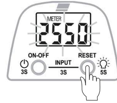
③ RESETボタンを1回押してください。前回セットした際のスピールの回転数が点滅して表示されます。(出荷時2550)
