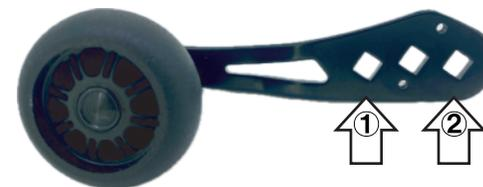
4.ハンドルを外し、長さを60mmにする場合は①の穴に、85mmにする場合は②の穴にシャフトを装着し2、1の逆の手順で装着します。
