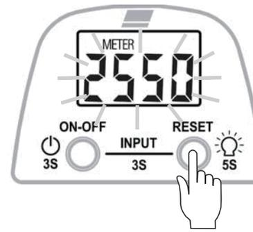
③ **RESETボタンを1回押し**てください。前回セットした際のスプールの回転数が点滅して表示されま
