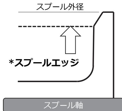
製品性能を十分に発揮させるためにも、図の**スプールエッジ**まで正確に糸を巻付けることをお奨めします。糸巻きの多すぎは、ラインのトラブルや糸入力時エラーが発生する可能性があります。
