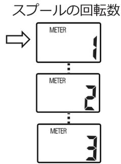
⑦ 糸を18ページに示す基準位置から**正確に20m（糸色 2色分）**引き出してください。引き出し始めるとスプールの回転数が表示されます。糸を引き出し過ぎた場合は、巻いてもどして
