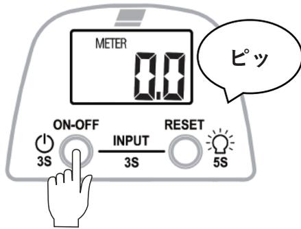
① スプールに糸を固定した状態からON-OFFボタンを3秒押ししてカウンターの表示をONにしてください。
