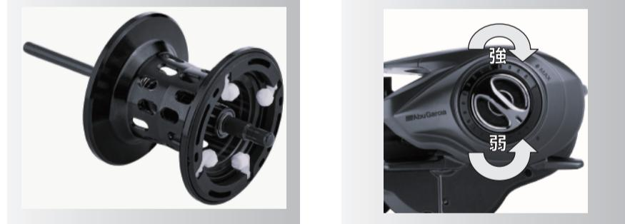
本機種のブレーキは遠心ブレーキを採用しております。ブレーキ力の調整は外部ダイヤルにて調整可能です。(スプール側の白いブレーキユニットは取り外し出来ません。) キャスティング時にバックラッシュ防止のため、スプールにブレーキ力が必要な場合は、本ブレーキのダイヤルを強側(MAX側)に調整して下さい。ルアーのウエイトや、風の状況により強弱を調整してください。
