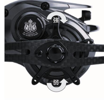
ドラグとは、魚が強く引いたときにラインを切られないように魚の引く力を合せてラインをスムーズに送り出すシステムです。正確にドラグを調整するには「バネばかり」を使用すると良いでしょう。スタートダラグを回転させてドラグ力の調整を行います。
