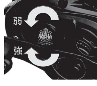
ノブを強く締めるとスプールの左右のガタが無くなりスプールにブレーキ力が発生します。ノブを弱く緩めるとスプールフリーが向上します。通常はスプールの左右のガタが無くなる程度に調整します。風が強く、キャスト時に糸が浮く時に締めこみ調整します。
