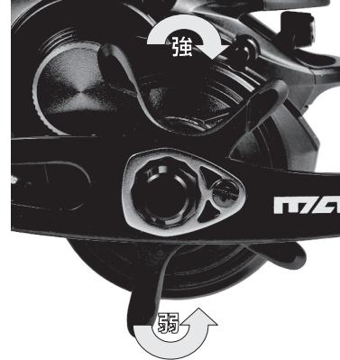
ドラグとは、魚が強く引いたときにラインを切られないよう魚の引く力に合せてラインをスムーズに送り出すシステムです。正確にドラグを調整するには「バネばかり」を使用すると良いでしょう。スタードラグを回転させてドラグ力の調整を行います。
