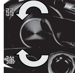
ノブを強く締めるとスプールの左右のガタが無くなりスプールにブレーキ力が発生します。ノブを弱く緩めるとスプールフリーが向上します。通常はスプールの左右のガタが無くなる程度に調整します。風が強く、キャスト時に糸が浮く時に締め込み調整します。
