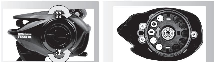
本機種のブレーキプレートはマグネットが 5箇所装着されています。ブレーキが強い場合は好みでマグネットの個数を調整することにより微調整が可能です。取り除く場合はドライバーの先などにマグネットをくっつけて外してください。マグネットは+ - が図のように交互に配列するようにセットしてください。装着する際は隣の磁石と向きが同じようにならないよう注意してください。
