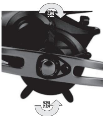
ドラッグとは、魚が強く引いたときにラインを切られないように魚の引く力に合わせてラインをスムーズに送り出すシステムです。正確にドラッグを調整するには「バネばかり」を使用すると良いでしょう。スタードラッグを回転させてドラッグ力の調整を行います。
