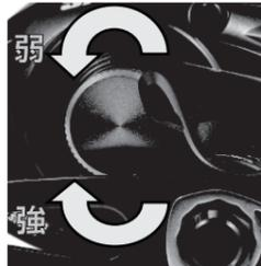
ノブを強く締めるとスプールの左右のガタが無くなりスプールにブレーキ力が発生します。ノブを弱く緩めるとスプールフリーが向上します。通常はスプールの左右のガタが無くなる程度に調整します。風が強く、キャスト時に糸が浮く時に締めこみ調整します。
