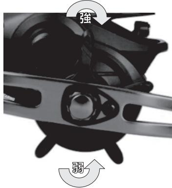
ドラグとは、魚が強く引いたときにラインを切られないように魚の引く力に合せてラインをスムーズに送り出すシステムです。正確にドラグを調整するには「バネばかり」を使用すると良いでしょう。スタードラグを回転させてドラグ力の調整を行います。
