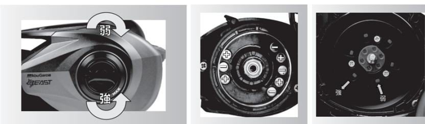
キャスト時にバックラッシュ防止のため、スプールにブレーキ力が必要な場合は、本ブレーキのダイヤルを強側 (MAX 側) に調整してください。ルアーのウエイトや、風の状況により強弱を調整してください。ピッチングするときはブレーキを弱く設定してください。※写真は右ハンドル仕様です。マグネットの数を変更する場合はマグネットの +, - が交互になるように配置してください。ビースト 300 はデフォルトで 8 個のマグネットがついています。スプールのパームサイド側についている遠心ブレーキを強くする場合は外側へ、弱くする場合は内側にカチッという音になるまでピンを動かしてください。
