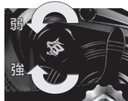
ノブを強く締めるとスプールの左右のガタが無くなりスプールにブレーキ力が発生します。ノブを弱く緩めるとスプールフリーが向上します。通常はスプールの左右のガタが無くなる程度に調整します。風が強く、キャスト時に糸が浮く時に締めこみ調整します。
