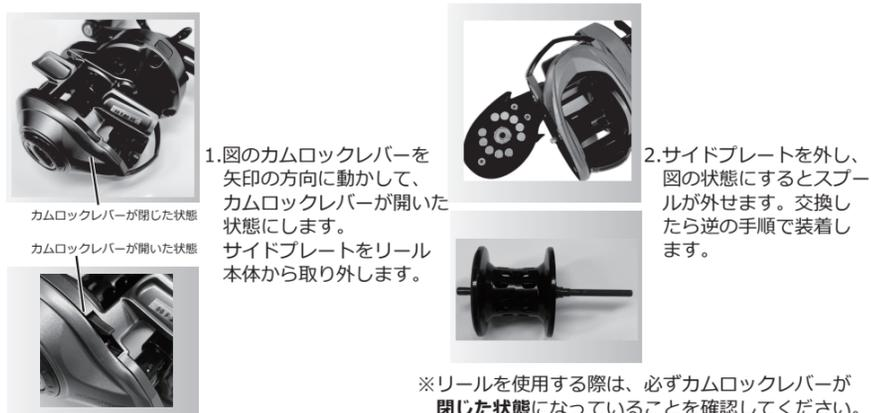
1. 図のカムロックレバーを矢印の方向に動かして、カムロックレバーが開いた状態にします。サイドプレートをリール本体から取り外します。
