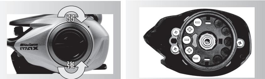
本機種のブレーキプレートはマグネットが 5 箇所装着されています。ブレーキが強い場合は好みでマグネットの個数を調整することにより微調整が可能です。取り除く場合はドライバーの先などにマグネットをくっつけて外してください。マグネットは + が図のように交互に配列するようにセットしてください。装着する際は隣の磁石と向きが同じようにならないよう注意してください。
