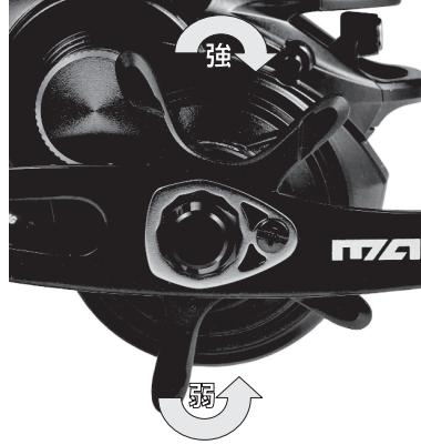
ドラグとは、魚が強く引いたときにラインを切られないように魚の引く力に合せてラインをスムーズに送り出すシステムです。正確にドラグを調整するには「バネばかり」を使用すると良いでしょう。スタードラグを回転させてドラグ力の調整を行います。
